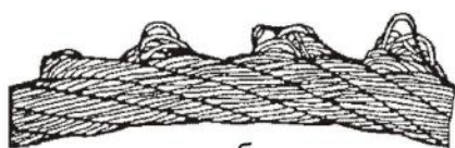
Рисунок Ж.4 Выдавливание проволок прядей: а - в одной пряди; б - в нескольких прядях
