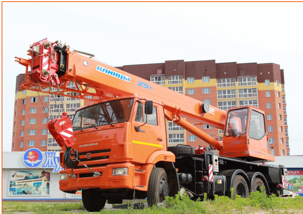
Автокран КС-55713-1К-1 на базе шасси КАМАЗ-65115 (6x4)
