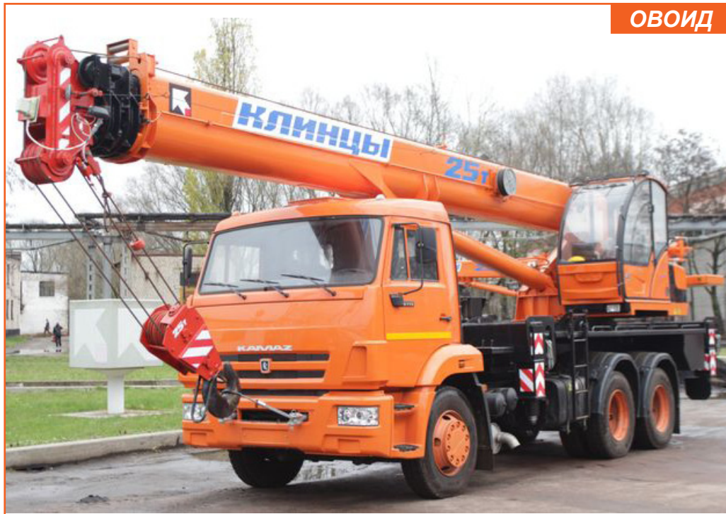
Автокран КС-55713-1К-4 на базе шасси КАМАЗ-65115 (6x4)
