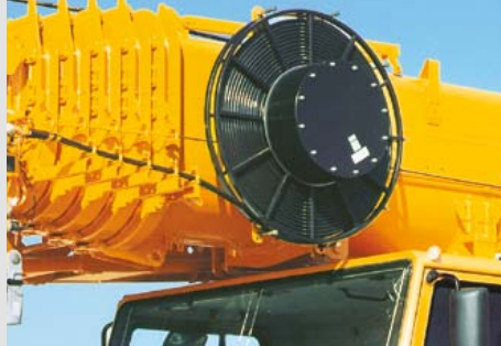
Барабан с шлангом для гидроцилиндра удлинителя
