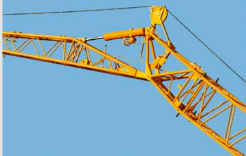
Управляемый откидной удлинитель (0° - 40°)
